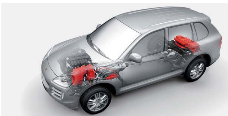
Die Ingenieure von Porsche in Weissach haben sich mit Blick auf den geplanten Cayenne Hybrid für die Entwicklung eines Parallel-Full-Hybrid entschieden.
