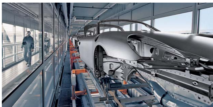
Die Produktion von Porsche Fahrzeugen läuft auf höchstem Niveau. Das Foto zeigt Elfer-Karosserien im Werk Zuffenhausen beim Transport in die Lackiererei.
